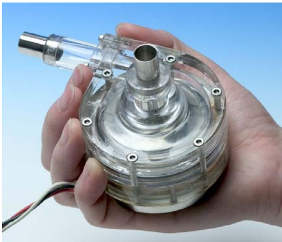
モノピボット遠心血液ポンプ
