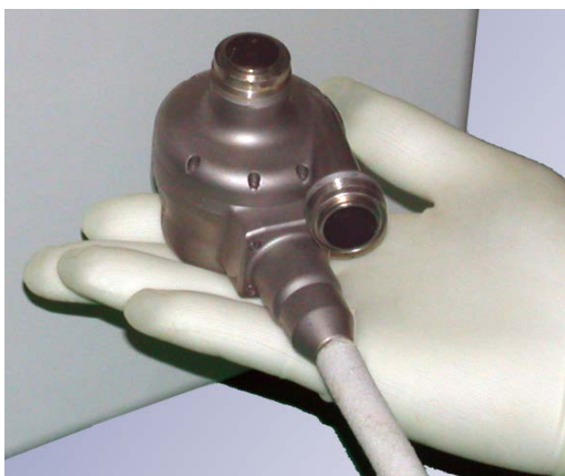
補助人工心臓 EVAHEART® (サンメディカル技術研究所)
